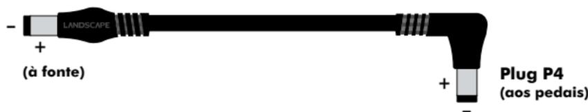
A maioria dos pedais funciona com plugs P4 2.1x5.5 com polaridade **CENTRO NEGATIVO** compatível com os cabos que acompanham a **ISOPOWER 4**. Em caso de dúvidas consulte o manual do fabricante do pedal ou informe-se com um técnico de sua confiança.
