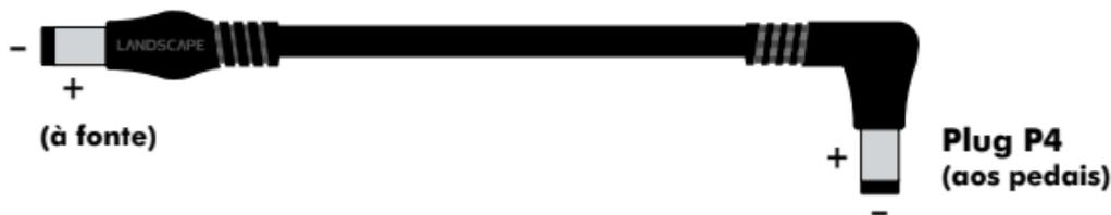
A maioria dos pedais funciona com 9VDC e plugs P4 2.1x5.5 com polaridade **CENTRO NEGATIVO** compatível com os cabos que acompanham a **ENERGY 10s**. Em caso de dúvidas consulte o manual do fabricante do pedal ou informe-se com um técnico de sua confiança.
